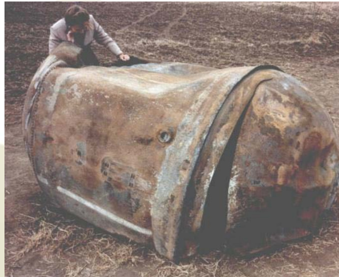
Haupttreibstofftank der zweiten Stufe einer Delta-2-Rakete, niedergegangen am 22. Januar 1997 in Texas, Foto: (c) NASA
